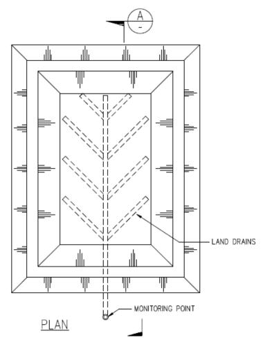
LEAKAGE DETECTION SYSTEM FOR A LINED LAGOON
